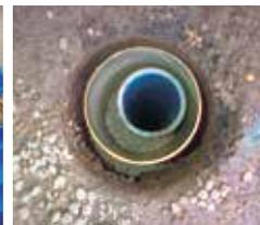
Detalle de un piezómetro
