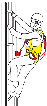
Uso de línea de vida con sistema anticaídas deslizante
