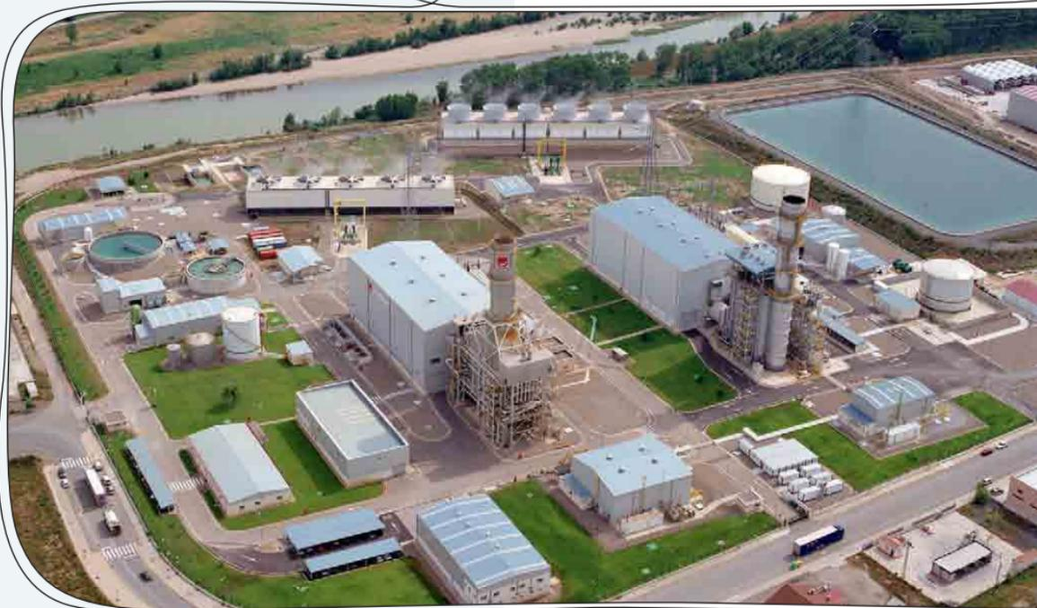
La instalación consta de dos grupos en funcionamiento, el primer grupo (Castejón 1) desde el año 2002 y el segundo (Castejón 3) desde comienzos de 2008. Cada uno de ellos se compone de una turbina de gas y una turbina de vapor dispuestas sobre un único eje, de modo que sólo disponen de un alternador para la generación de energía eléctrica instalado entre ambas turbinas.
